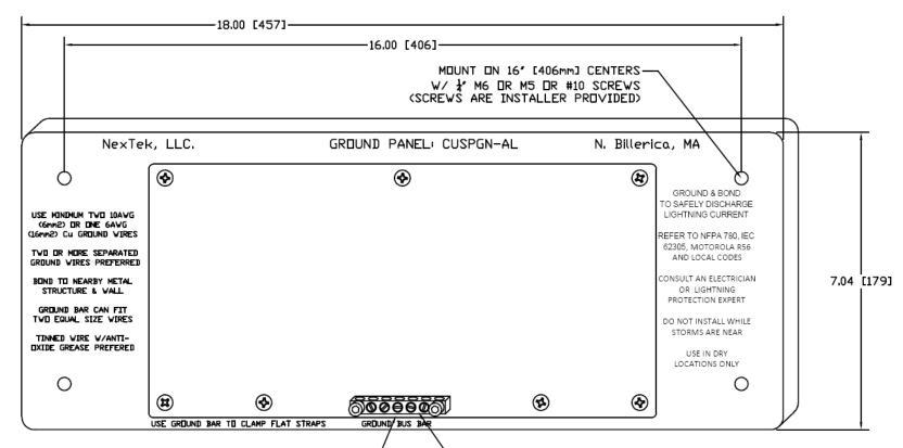
FLAT STRAPS CAN BE CLAMPED UNDER GROUND BUS-(FLAT STRAPS ARE INSTALLER SUPPLIED)
